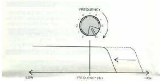
NOISE BUSTERは、信号中の中高音域の量に応じてフィルターの周波数帯域を移動させ、入力された信号の最も高い周波数までを通し、それ以上の周波数をカットします。フリケンシーを右に回すほど、高音域の信号も通過しますが、ノイズもいっしょに通過します。
