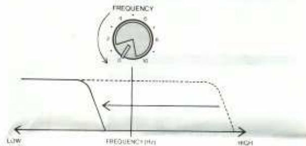
Die Filterfunktion des NOISE BUSTER richtet sich nach den im Signal enthaltenen Frequenzen und ist nur dann vorhanden, wenn im Signal Mitten und Höhen enthalten sind. Alle Frequenzen oberhalb des Grenzwerts werden automatisch weggefiltert. Je weiter Sie den Regler nach rechts drehen, desto höher liegt die Grenzfrequenz und desto mehr Rauschen wird durchgelassen.
