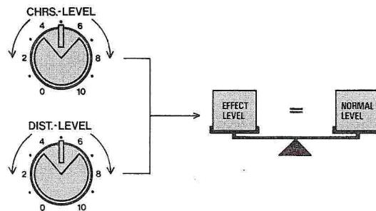
④ CHORUS LEVEL と DISTORTION LEVEL を調整して CHORUS と DISTORTION のバランスをあわせます。
